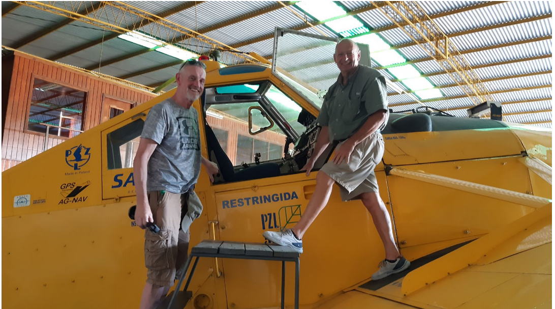
Hier erklärt mir William Santos in seiner Firma Santos Aeros Servicios die Technik von Agrarflugzeugen, in diesem Fall eine PLZ M18 Dromader (Dromedar) mit einem 9-Zylinder-Sternmotor und 980 PS. Eine Maschine von William Santos ist mit einer Turbine ausgestattet.
